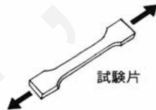
引張強さは 鋼材の最も基本的な機械的性質の代表といえる
